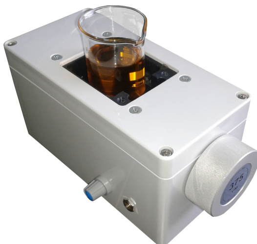
Рисунок 11 – Установка стакана с анализируемым раствором в кюветном отделении фотометрической ячейки
